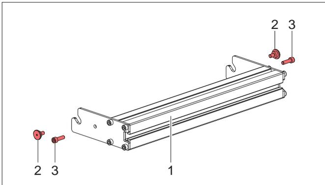
Der Bügel ist ein Montageelement, um Drucker der Serien HERMES Q und Hermes+ hängend in eine Produktionslinie zu integrieren.
